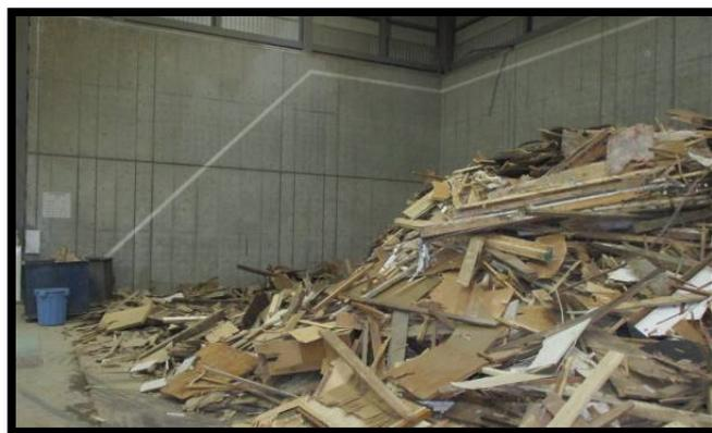
破碎後：保管面積／103.0 m<sup>2</sup>、保管高さ／4.0m、保管容量／329.6 m<sup>3</sup>
